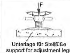
Detail X - Stellfuß / ADJUSTMENT LEG (ohne Maßstab / WITHOUT SCALE)
